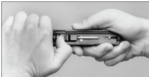
7 pav., d. Gražiklio išėmimas
