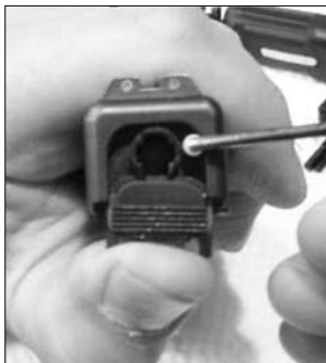
34 pav. Skiltuvo ir išmetiklio spaudiklio su spyruokle įstatymas į spyną ir spynos dangtelio pritvirtinimas prie spynos
