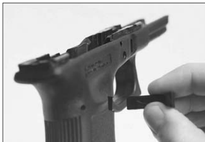
22 pav. Dėtuvės fiksatoriaus (19) atskyrimas nuo rėmo
