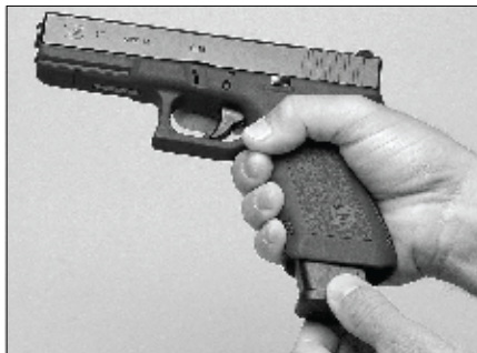
7 pav., a. Šovinių dėtuvės išėmimas
